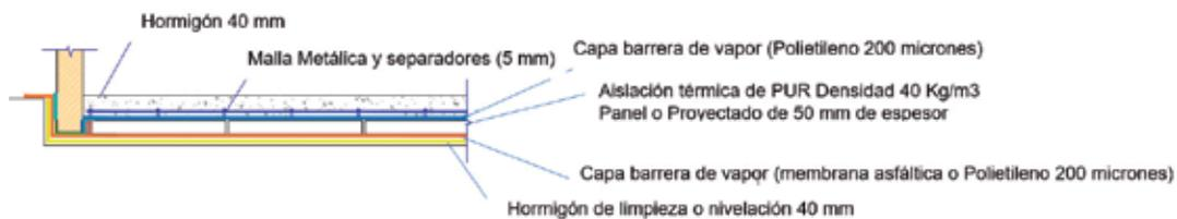
*Aislación Térmica Eficiente con Poliuretano en pisos en contacto con terreno natural*
